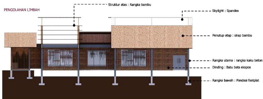
Gambar 9. Konsep Struktur bangunan utama Sumber : Analisa Pribadi, 2022
