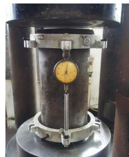
Gambar 4. Pengujian modulus elastisitas
