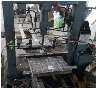
Gambar 7. Pengujian kuat lentur panel
