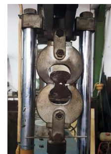
Gambar 6. Pengujian kuat tarik mortar
