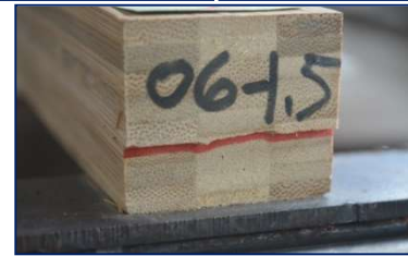
Gambar 6. Pengujian Gagal Geser Pada Balok Bambu Laminasi Dengan Incising 6x6 Mm Tekanan Kempa 1,5 MPa.
