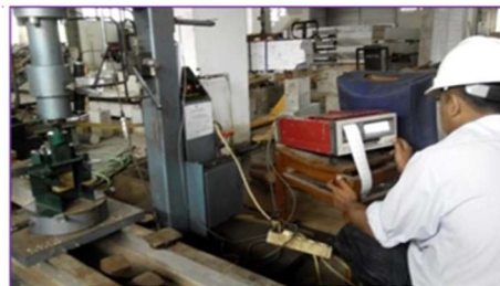
Gambar 3. Persiapan Pengujian Kuat Geser Laminasi Balok Bambu.
