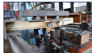
Gambar 7. Pengujian Gagal Geser pada Balok Bambu Laminasi Dengan Jarak Laminasi 8x8 Mm Tekanan Kempa 1,5 MPa.
