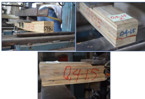
Gambar 5. Pengujian Gagal Geser Pada Balok Bambu Laminasi Dengan Jarak Incising 4x4 Mm Tekanan Kempa 1,5 MPa.
