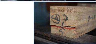
Gambar 4. Pengujian Gagal Geser Pada Balok Bambu Laminasi Referensi Dengan Tekanan Kempa 1,5 MPa.
