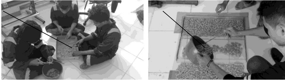
Gambar 1. Tahap daun nipah digunting, tahap daun nipah dicampur resin dan hardener
