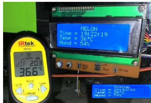
Gambar 4 Pengukuran kinerja sistem untuk pantauan suhu dan kelembaban dalam ruangan
