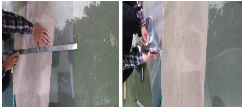
Gambar 3. Pengukuran dan Pemotongan Lembaran Polystyrene 500 mm x 500 mm
