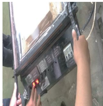
Gambar 8. Mengangkat Penjepit ke Vacuum Chamber
