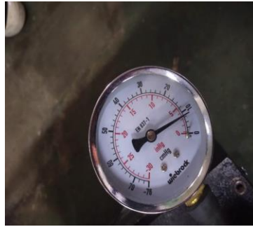
Gambar 9. Setting Tekanan Pemvakuman
