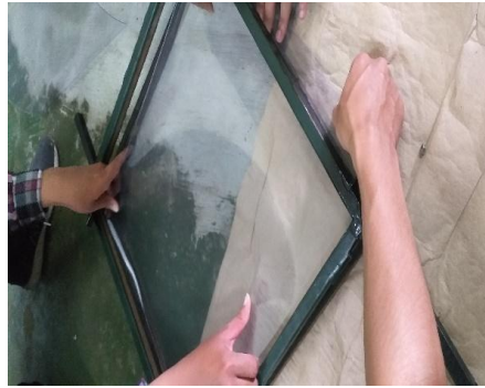
Gambar 5. Menjepit Lembaran Polystyrene pada Penjepit Material
