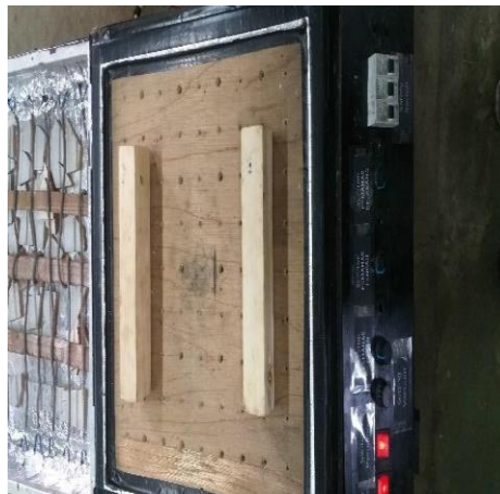
Gambar 4. Peletakan Cetakan diatas Vacuum Chamber
