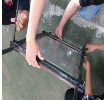
Gambar 12. Melepas lembaran polystyrene dari penjepit material polystyrene
