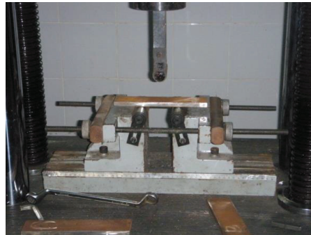
Gambar 6.1 mekanisme uji bending
